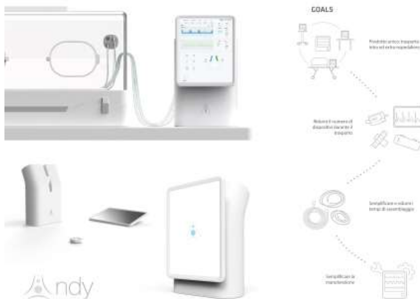
Fig.1 Andy, ventilatore polmonare di nuova generazione per la TIN progettato grazie all'applicazione delle metodologie proprie dell'Ergonomia per il Design e dello Human-Centred Design, semplifica ogni fase della cura del paziente, migliorando le operazioni di assistenza ventilatoria. Il concept del nuovo ventilatore ha cercato di raggiungere i seguenti obiettivi: a) sviluppo di un unico prodotto utilizzabile sia in terapia intensiva neonatale che durante il trasporto; b) riduzione del numero di dispositivi durante il trasporto; c) semplificazione e riduzione dei tempi di assemblaggio; d) facilitazione del passaggio alle diverse modalità di ventilazione senza alcuna disconnessione del paziente; e) semplificazione delle attività di manutenzione.
